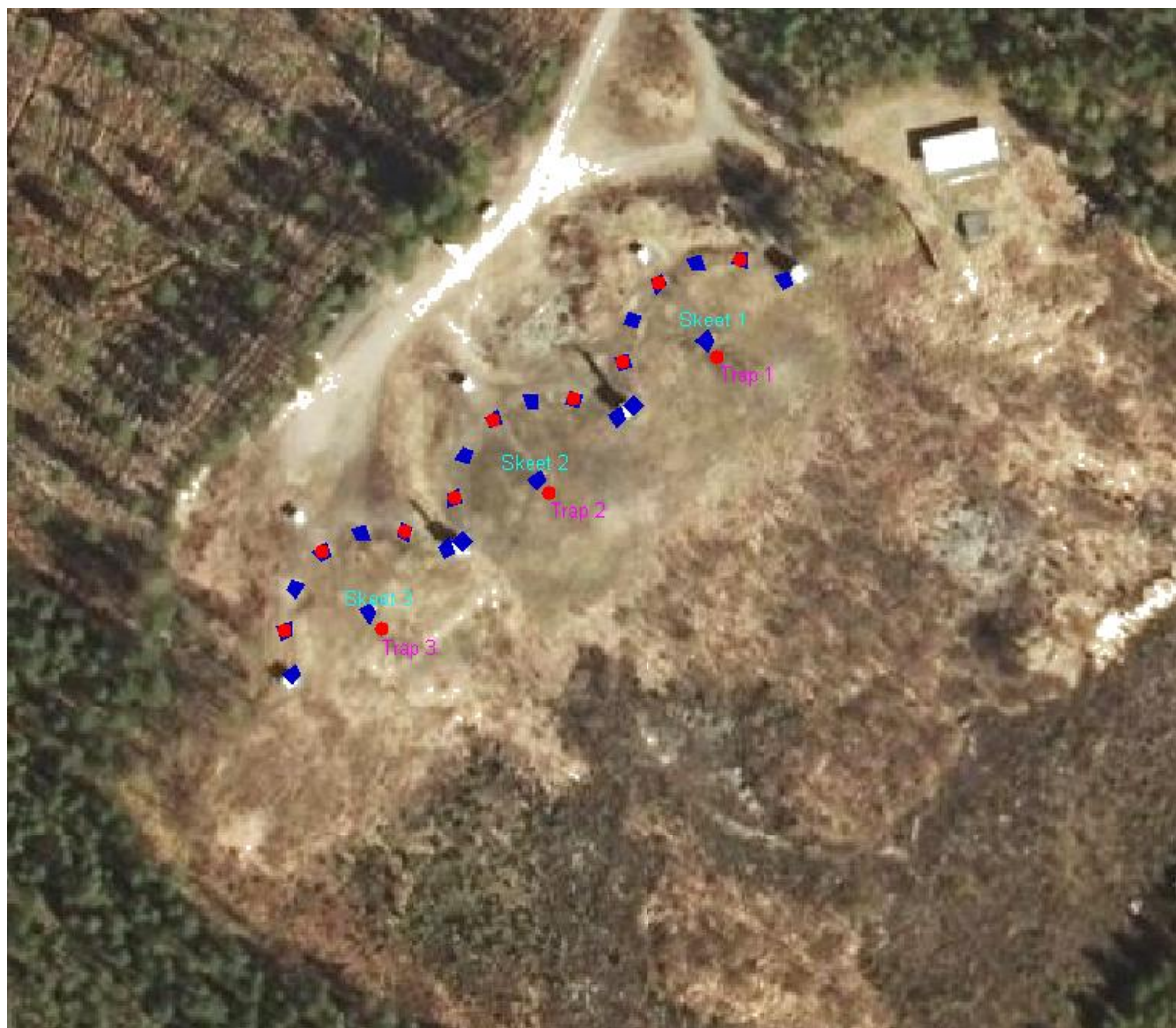
Kuva 2.1.2. Uusi ratasijoittelu. Sinisellä skeetin ampumapaikat, trapin ampumapaikat tulevat skeetradan etupuolelle. Melumallissa mallinnetut paikat on kuvassa punaisella ympyrällä.
