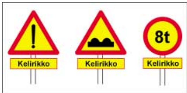
Kuva 4: Esimerkkejä kelirikkoteillä käytettävistä varoitus- ja rajoitusmerkeistä.
