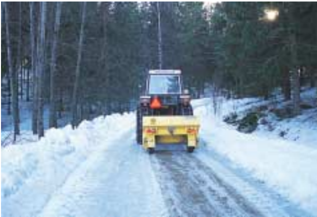
Kuva 37: Hiekoitukseen, kuten myös suolan levittämiseen, voidaan käyttää myös tavallisia maatalouskoneita.
