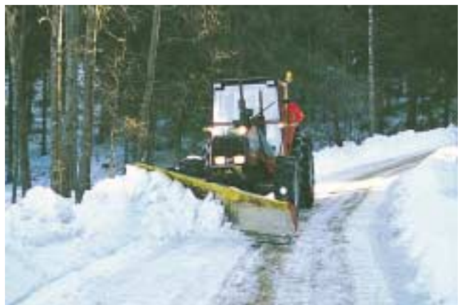
Kuva 33: Auraus on yleensä tehokkain työmenetelmä lumenpoistoon.
