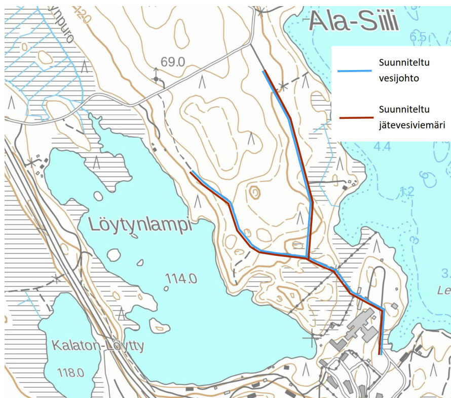
Kuva 8. Alustavat suunnitelmat vesi- ja jätevesijohtojen sijoittamisesta alueelle. Nykyistä verkostoa jatkettaisiin vankila-alueelta suunnittelualueelle.
