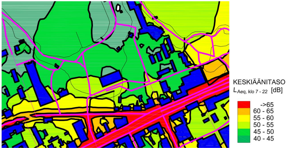
Kuva 10. Ote päiväajan (klo 07-22) melumallinnuskartasta, yhdistetty ajoneuvoliikenteen ja rautatieliikenteen keskiäänitaso L_{Aeq} (Pieksämäen kaupungin meluselvitys 2010, FCG)
