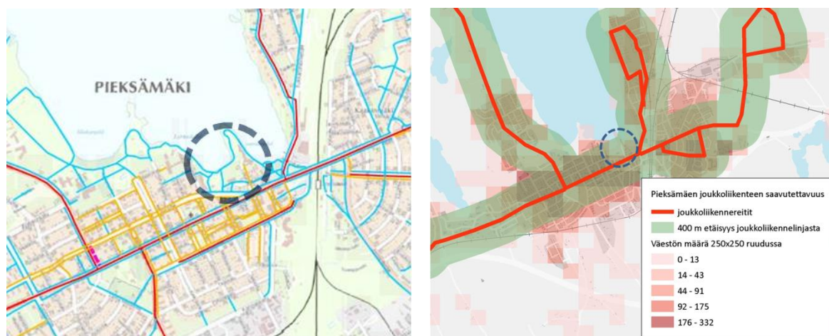
Kuva 7. Vasemmalla kuvassa suunnittelualueen sijoittuminen keskusta-alueen kevyen liikenteen verkostoon. Kuvassa punaisella kevyen liikenteen laatuikäytävät, sinisellä kevyen liikenteen väylät, keltaisella jalkakäytävät. (Pieksämäen liikenneverkko-suunnitelma, Ramboll 2014) Oikealla kuvassa suunnittelualueen sijoittuminen kaupungin sisäisiin joukkoliikennereitteihin nähden. (Pieksämäen liikenneverkko-suunnitelma, Ramboll 2014)
