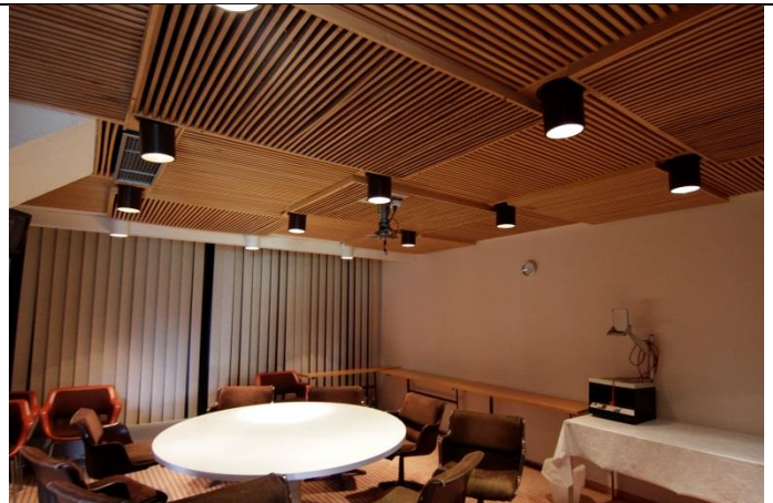
Alkuperäisen huoneisto-osan alle rakennettujen kokoustilojen pienempi kokoushuone. Sisäkatossa on käytetty puuritulöitä, joiden osaksi valaistus on integroitu. Kalustuksena on mm. Olli Mannermaan Kilta -tuoleja.
