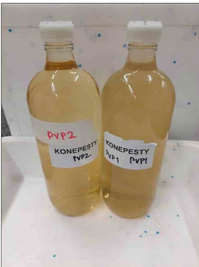
Kuva 10. Pohjaveden havaintoputkista otetut vesinäytteet olivat väriltään ruskeahkoja.
