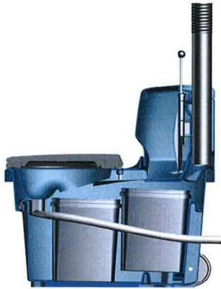
Kuva 14: Erotteleva kuivikekäymälä voidaan asentaa niin ulko- kuin sisäkäyttöön. Käymälä ei vaadi toimiakseen vesi- eikä sähköliitettä (Biolan 2010)
